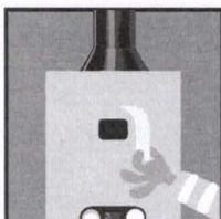
отсутствие тяги в дымоходе газовой колонки или котла, негерметичность соединений труб с дымовым каналом
